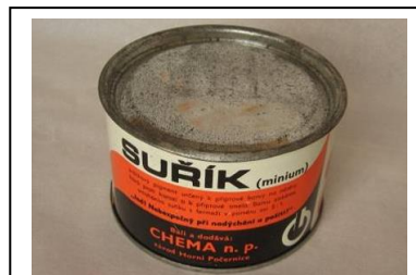
Suřík se ve směsi s fermeží dřívě používal jako základový nátěr
